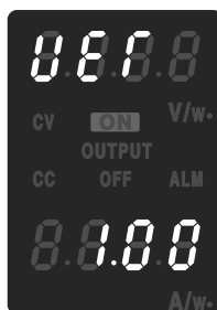
図 3-1 電源投入時のバージョン表示例
