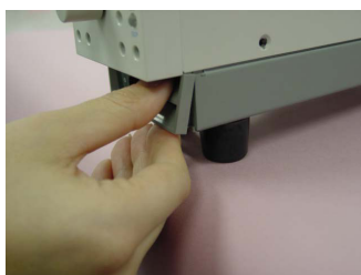
図 7-1 ルーバの取り外し
