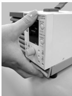
図 7-5 ルーバの取り外し
