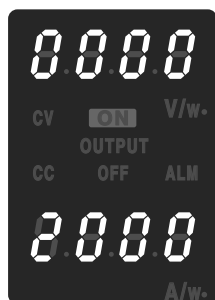
図 5-4 直列運転スレーブ機の設定例
