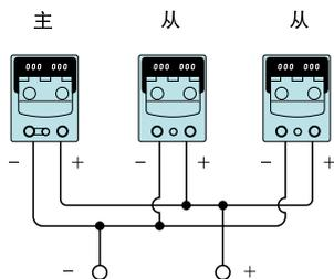
● 并联连接相同机型，可增加电流容量。输出控制可通过 1 台主机 (主) 进行。
