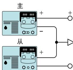
● 串联连接，努力增大输出电压的方法。控制时，上侧 (正极一侧) 的型号为主机 (主)，仅 1 台操作时，也可控制从机 (从) 的输出。
