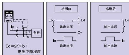
● 补偿因电源和负载间的配线或者其接触电阻而导致的电压下降的方法。电压下降在电流越大时会成为问题，但打开感测开关，将电压传感点移至负载端，可以防止每一侧下降 0.6V 左右。
